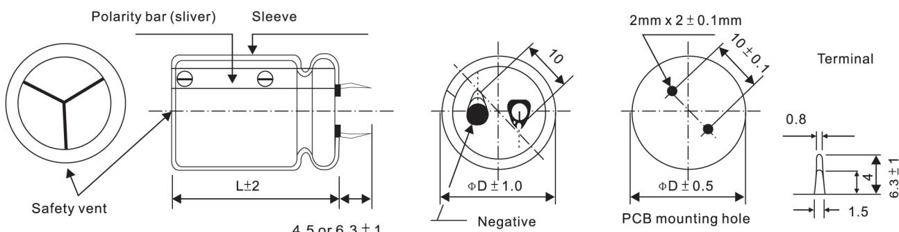
◆ LARGE ALUMINUM ELECTROLYTIC CAPACITORS LZX Snap-in 105°C
